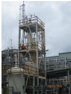
รูปที่ 6 ระบบบำบัดสารอินทรีย์ระเหยแบบเปียก (VOCs Wet Scrubber)
