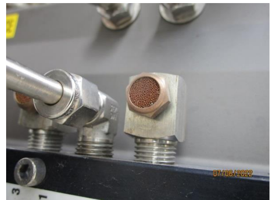
รูปที่ 11 การติดตั้งอุปกรณ์ลดเสียง
